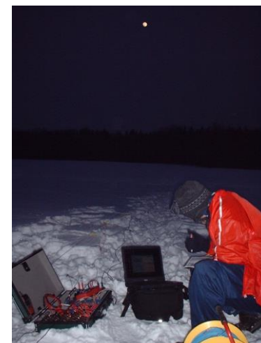
Електрометријско сондирање (Словенија)
